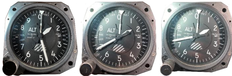
Figur 13. Skillnad i höjd på de tre höjdmätarna vid olika tryckinställning.
