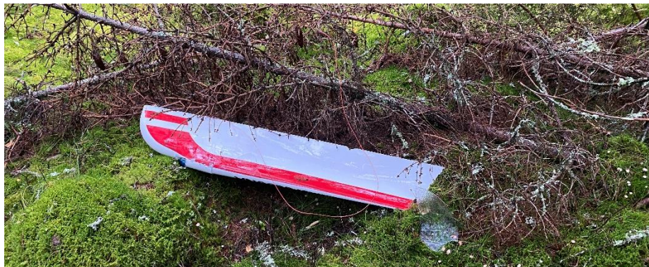
Figur 10. Flygplanets högra vingpets, 1 427 fot (435 meter) över havsytan.
