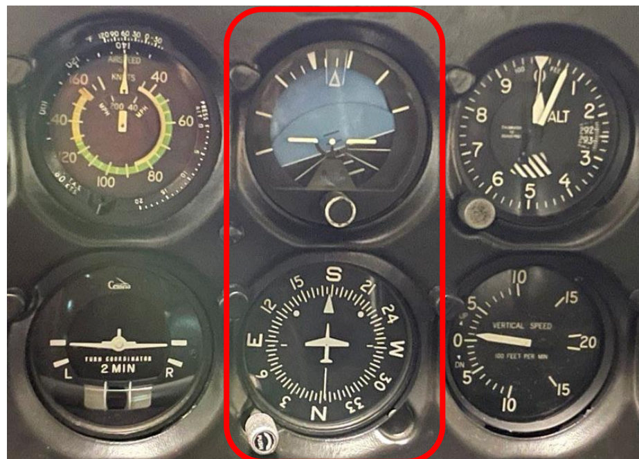
Figur 4. Instrumenteringen på flygplansmodellen Cessna 172N med horisont- och kursgyro i röd ram infogad av SHK. Bild: Robert Ödlund.
