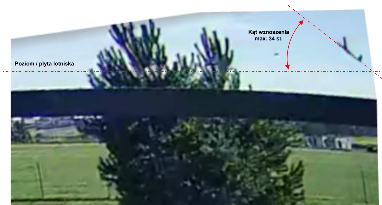
Rys. 8. Przybliżone określenie maksymalnego kąta wznoszenia na ciągu (po uwzględnieniu zniekształcenia obiektywu)
