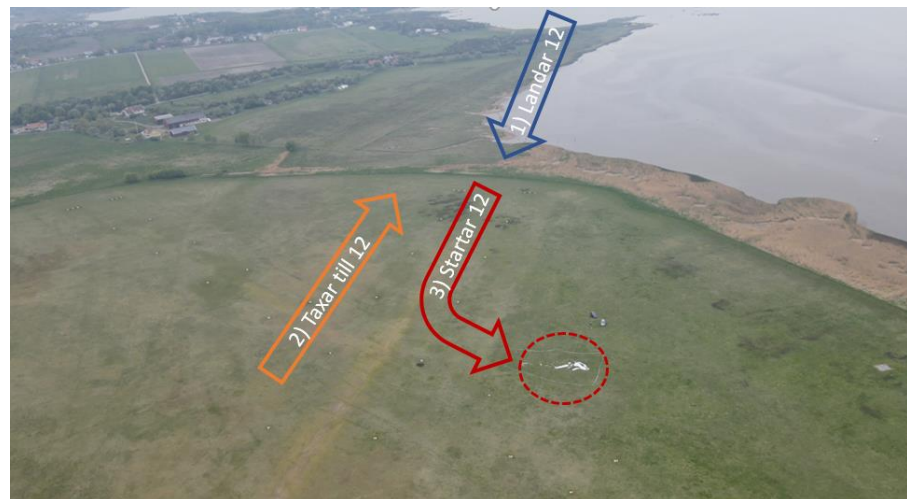
Figur 10. 1) Blå pil visar landning på bana 12. 2) Orange pil visar taxning tillbaka till bana 12 efter landning. 3) Röd pil visar ungefärlig riktning av det troliga olycksförloppet. Flygplanets slutliga position (markerad med röd streckad ring), skadorna på marken och vrakdelarna påvisar att flygplanets mest troliga rörelseriktning var i den röda pilens riktning. Publiceringstillstånd från Lantmäteriet: LM2023/013646.
