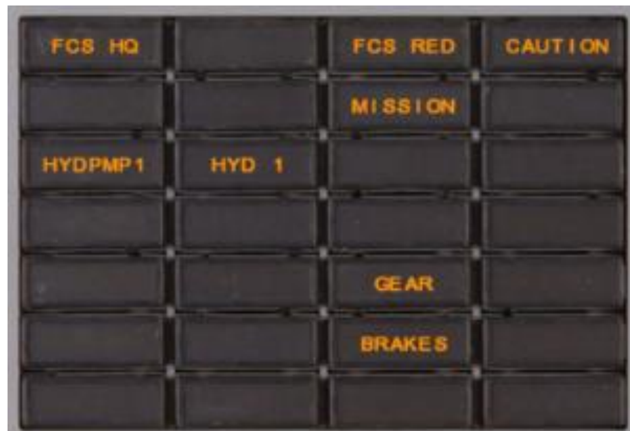
Figur 6. Felvarningspanelen (CWP) med åtta varningar som flygplanet hade ca 11 minuter före landningen. Källa: Försvarmakten.
