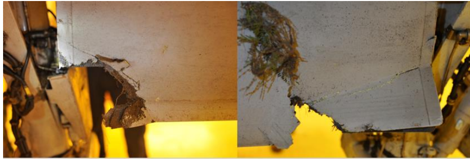
Figur 25. Bild på vänster och höger noslandställslucka med skador på de främre delarna. Foto: Saab AB.
