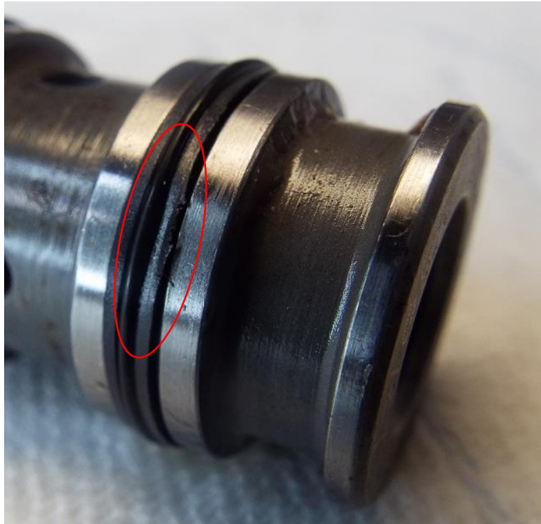
Figur 35. Hylsan med o-ringar och stödringar efter testet. Påverkade stödringar markerade av SHK. Foto: Heroux Devtek.
