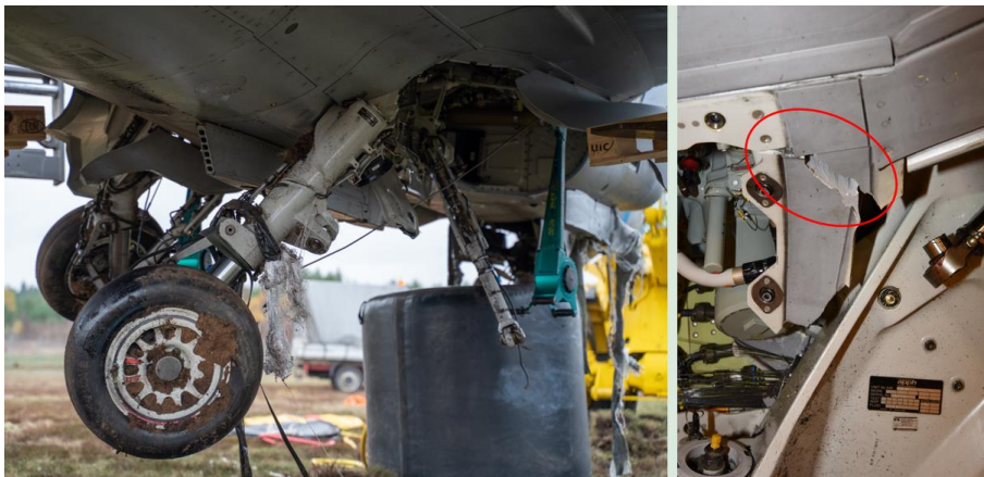
Figur 24. Den vänstra bilden visar skadorna på huvudlandställen. Den högra bilden visar det skadade kroppsspantet bakom höger huvudlandställ. Markering införd av SHK. Foto: Försvarmakten.
