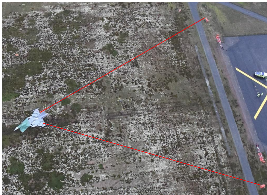
Figur 28. Bild på flygplanets slutposition efter utrullningen i nätet. Bromslinorna är markerade av SHK med röda linjer. Foto: Försvarmakten.
